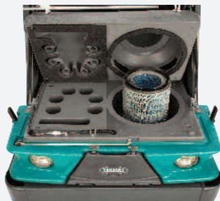
**Mejore el rendimiento de barrido y alargue la vida útil del filtro** mediante la filtración mejorada del filtro de aire y el sistema de control de polvo SweepMax™ de tres etapas.
