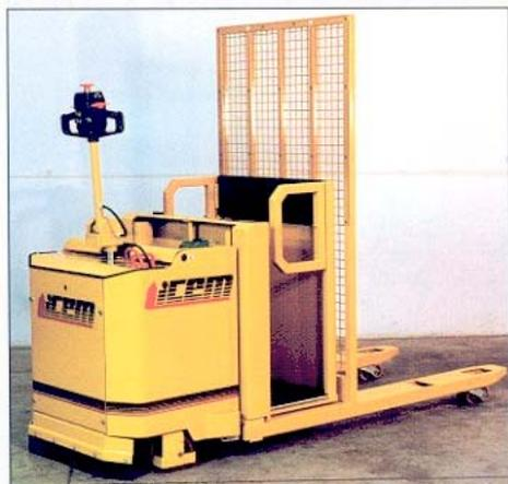
GL Picking con protecciones laterales y con parilla de carga.
