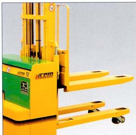
Versión TE-DS con sistema de palancas para la elevación de las horquillas del suelo para superar las rampas.
