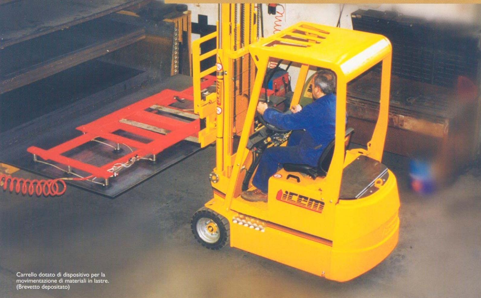
Carrello dotato di dispositivo per la movimentazione di materiali in lastre. (Brevetto depositato)
